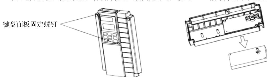
图 1-3-3 卸下键盘面板 ( $\leq 22\text{kW}$ )
